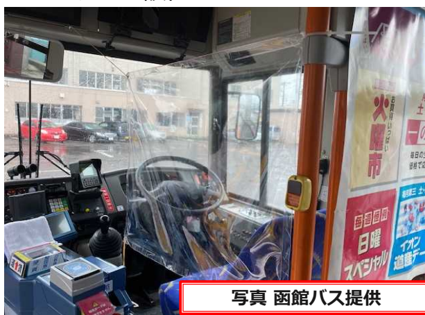
運転席を仕切る飛沫防止用ビニールカーテンの設置
