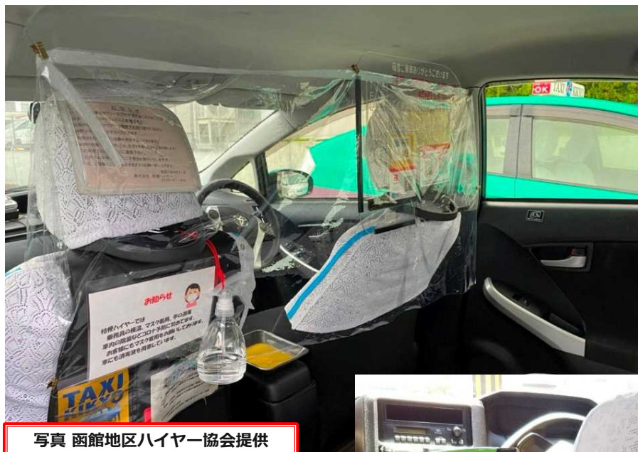
後部座席を仕切る飛沫防止シートの設置
